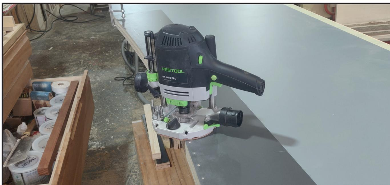
S'ensuit un long travail de collage d'alaises à l'aide de bande cache et ensuite d'affleurage tout en faisant attention à ne pas abîmer le stratifié. Pour l'affleurage, nous dégrossissons avec une affleureuse avec guide parallèle et finissons avec une combinaison de racloirs et rabot de paume.
