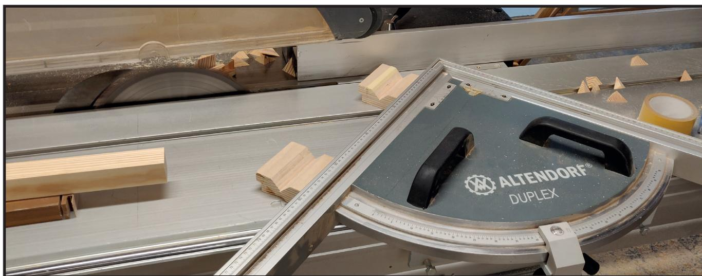
J'effectue cette opération sur toutes les pièces et je peux ensuite tronçonner d'équerre avec le guide perpendiculaire classique. Le guide parallèle à positionnement numérique me permet de changer de butée entre les opérations sans perte de précision. Après tout ce tronçonnage, il faut poncer les 2 faces visibles qui ont été coupées à la scie.
